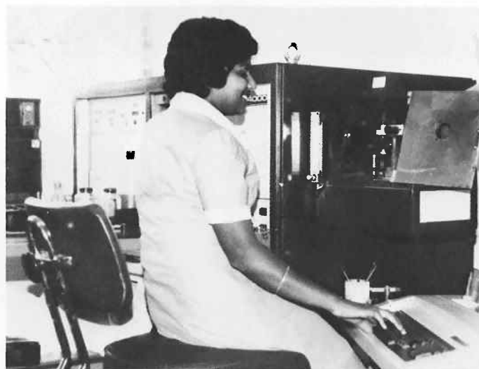
2. Från tangentbordet ges analysdirektiv till datorn som styr och kontrollerar spektrometern.
