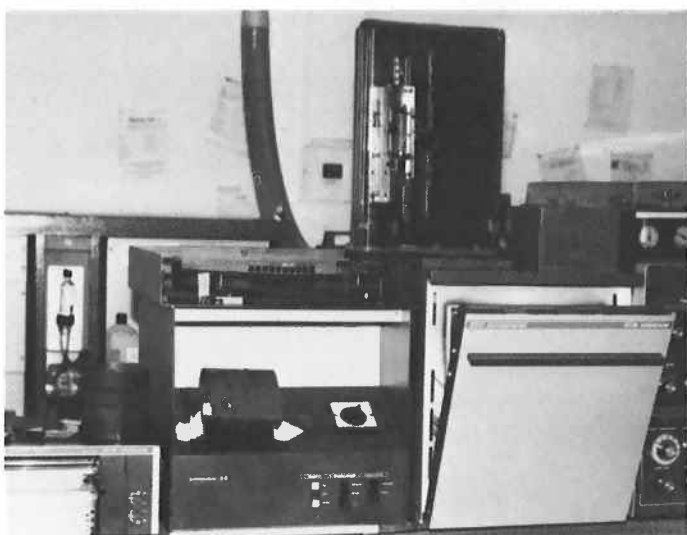
3. Helautomatisk gaskromatograf för analys av bränsleförtunning.
